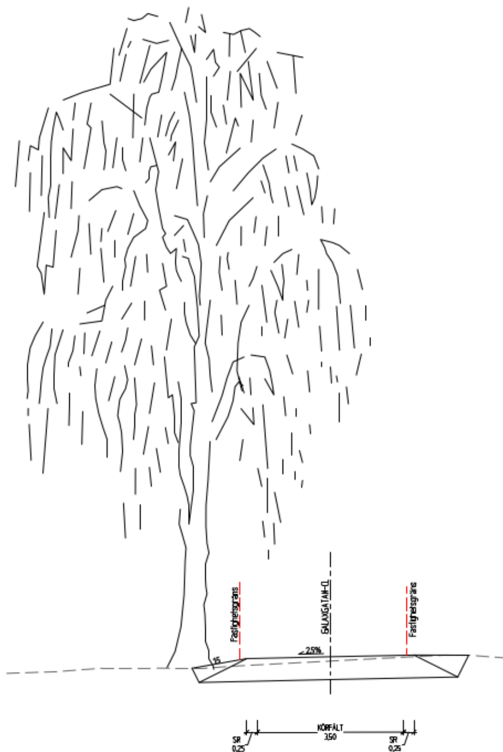
Figur 24. Typsektion för östra delen av Galaxgatan, sektion G, vy österut.
